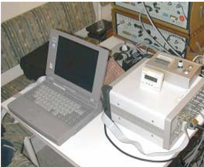
Messplatz zur Erfassung von Erschütterungen
